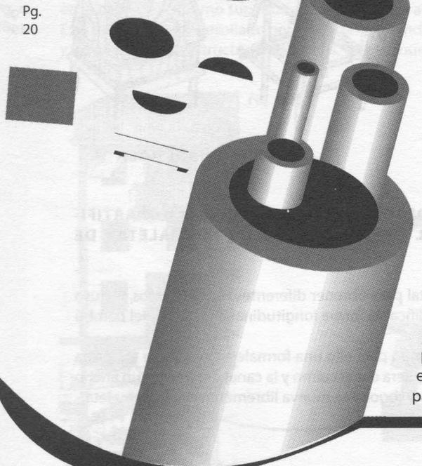
En este sistema de deformación por medio de formaletas de madera también se utiliza para la deformación transversal del culmo con el fin de hacer culmos de sección cuadrada o rectangular. Solo que en este caso el perímetro interno de la formaleta equivalente a la suma de sus cuatro lados, debe ser casi igual al perímetro del cogollo.
