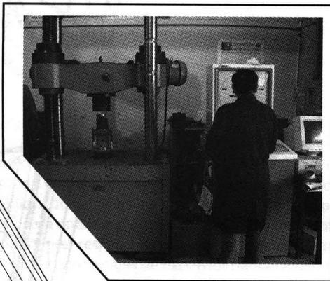
Con las lecturas de desplazamiento vertical obtenidas y las cargas aplicadas, se calculó el módulo de elasticidad aparente (suponiendo que la deformación total se debe sólo a la deformación por flexión). Para vigas largas el módulo de elasticidad aparente se puede aproximar al módulo de elasticidad de la viga.
