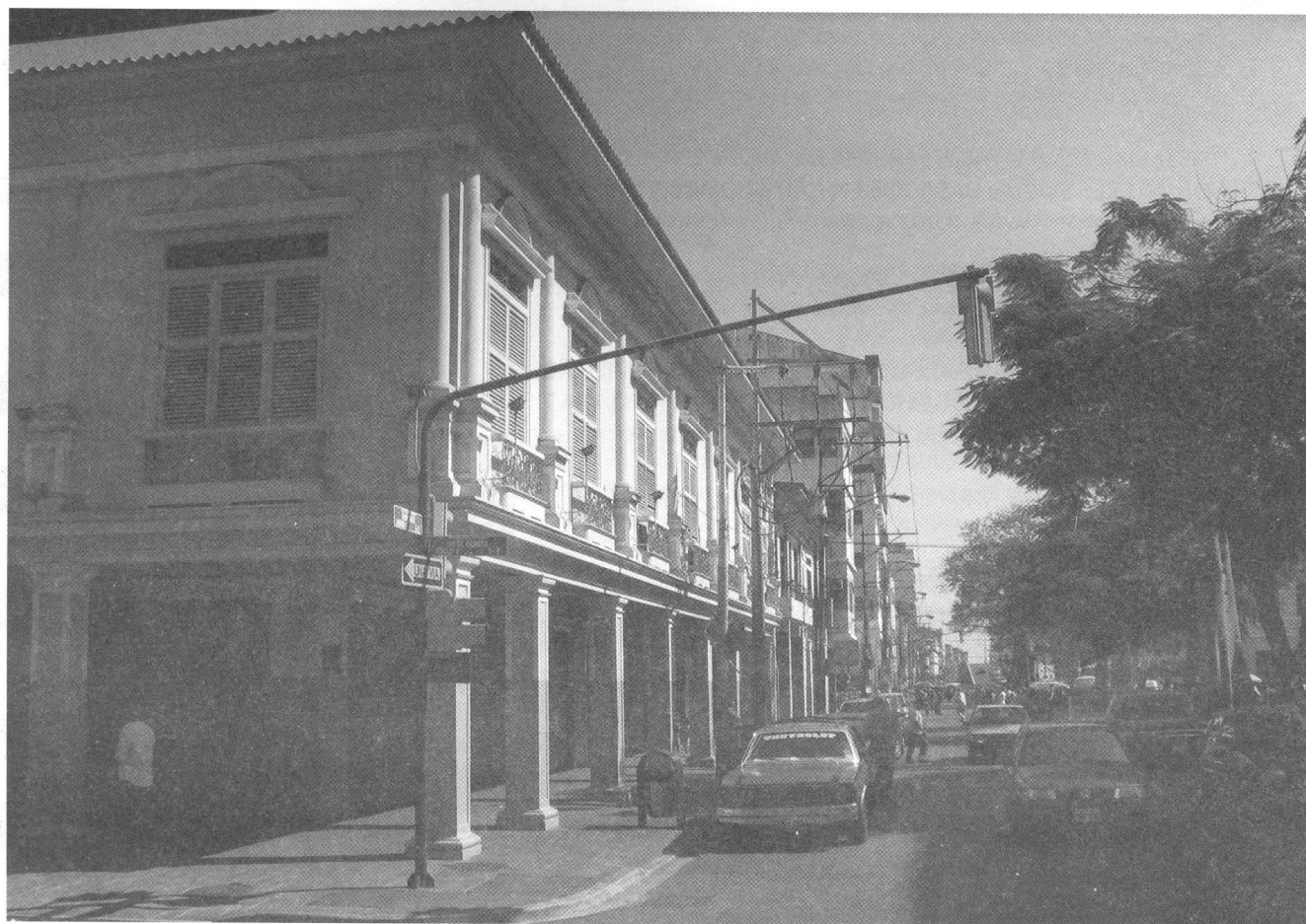
Foto 1 Soportales protegen de la radiación solar a los peatones en Guayaquil, Ecuador. Fuente Erik Johansson
