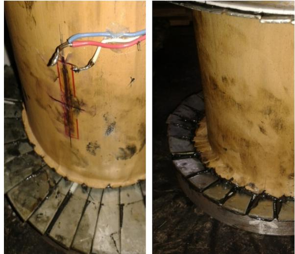
**Figura 3.** Muestras ensayadas a compresión simple.
