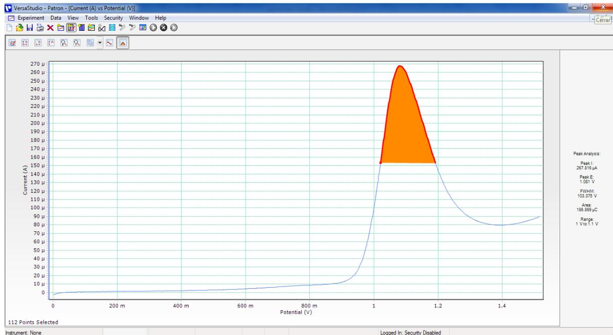
**Figura 4.** Voltograma de la sustancia patrón de ácido acetil salicílico (AAS)
