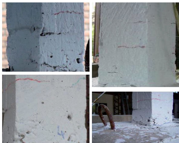
Figura 8. Fisuras en columnas del pórtico sin refuerzo, luego de aplicar los 6 inputs dinámicos.
