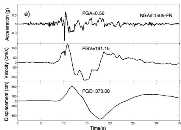
Figura 1. Historia de tiempo de aceleración, velocidad y desplazamiento del suelo de los registros seleccionados. a) 171; b) 174, c) 983, d) 1119 y e) 1505.
