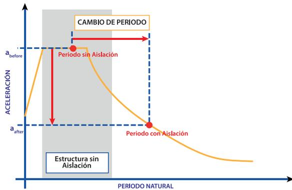
**Figura 2.** Principio en que se basa el diseño sísmico con aislamiento de base.
