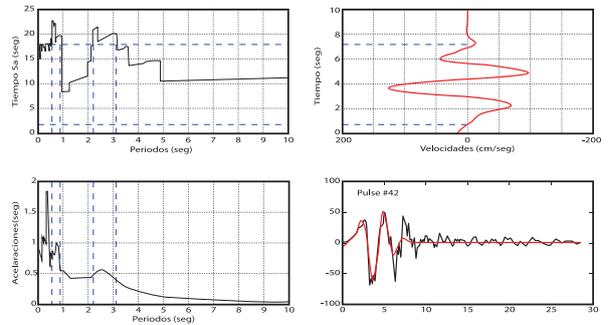
**Figura 7.** Diagrama compuestos V-E-T para Imperial Valley-06 (1979) estación El Centro Array #11 (#174).
