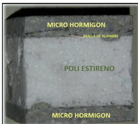
**Figura 1.** Estructura del sistema constructivo HORMYPOL.
