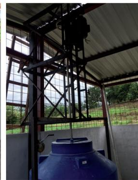
**Figura 3.** Mezcladora vertical (vista superior).
