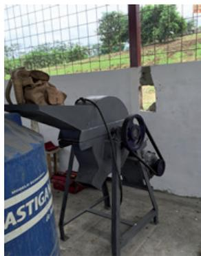
**Figura 2.** Molino de martillo (vista lateral).
