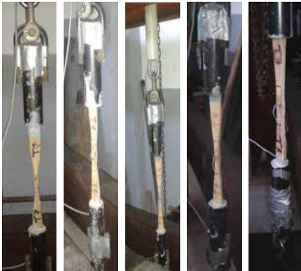
**Figura 6.** Ensayo de tracción paralela a la fibra.
