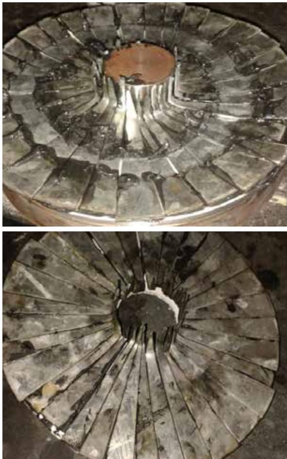
**Figura 2.** Placa elaborada para el ensayo de compresión libre de fricción en la muestra. que permite el deslizamiento horizontal.
