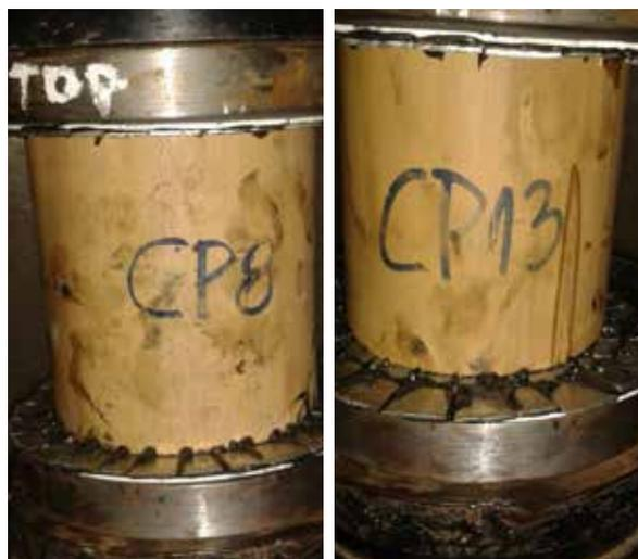
**Figura 1.** Ensayo de compresión simple paralela a la fibra.
