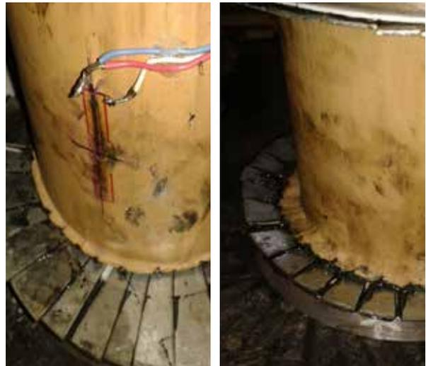
**Figura 3.** Muestras ensayadas a compresión simple.
